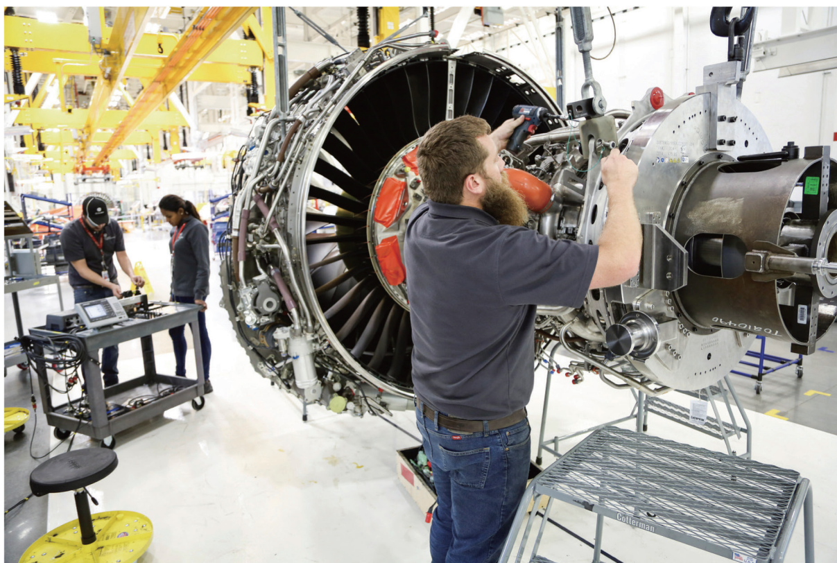
GE 公司的 LEPA 发动机正在印第安纳州的 Layfayette 进行维修。
