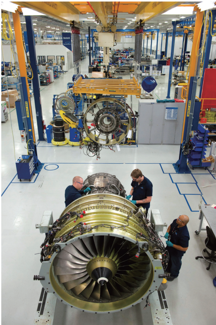
CFM 国际公司的 CFM56 发动机正在加拿大温尼伯 StandardAero 公司的 MRO 车间进行维修。
