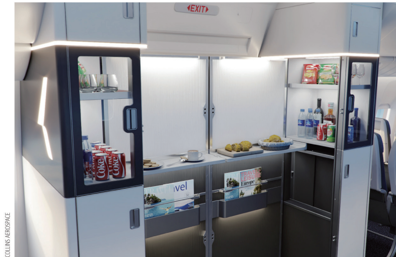
柯林斯宇航的 M-Flex Duet 在飞机飞行时可以将出口处变成一个小吃店。
