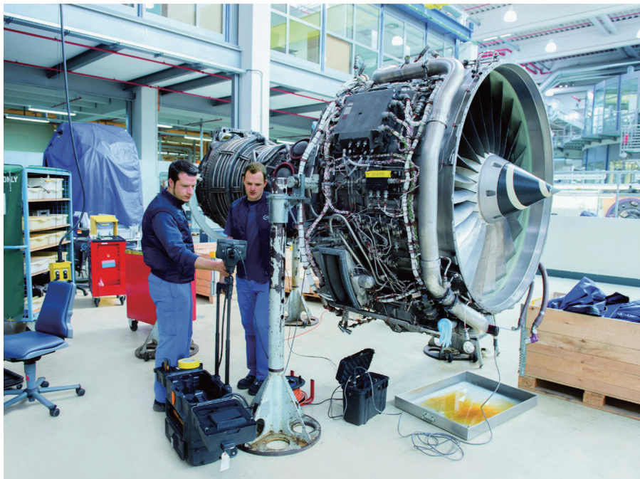
IAE 公司的 V2500 发动机正在 MTU 汉诺威维修中心进行维修
